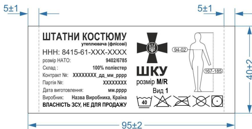
Рисунок 2 — Зовнішній вигляд етикетки виробу та її розміри
