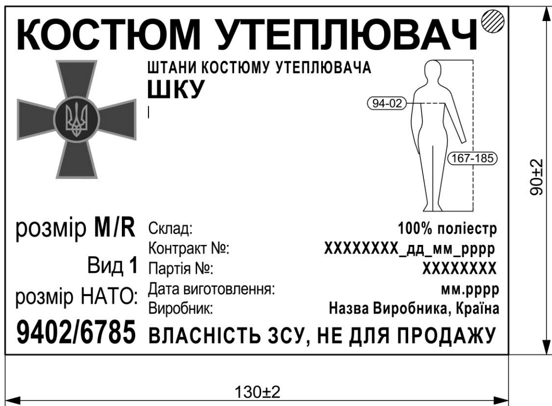
Рисунок 3 — Зовнішній вигляд товарного ярлика та його розміри
