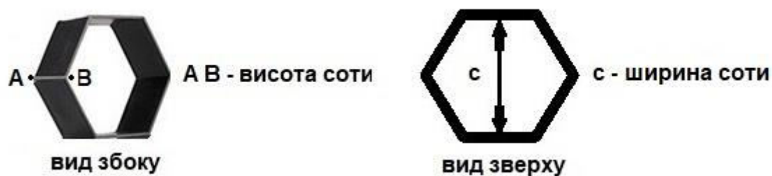
Рисунок 6 – Сота зовнішньої захисної сітки із поліуретану
