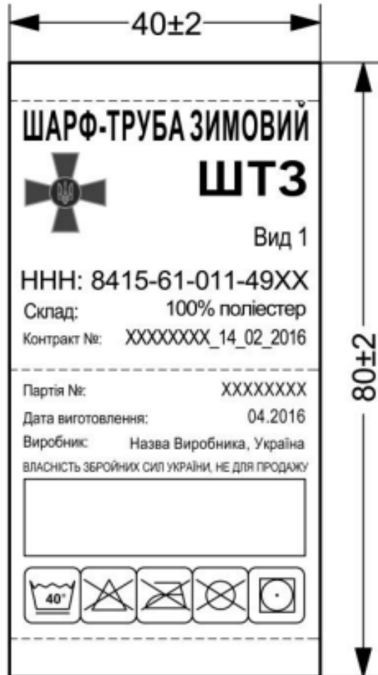
Рисунок Д5.1 – Зовнішній вигляд та лінійні виміри етикетки предмета (Клас А)
