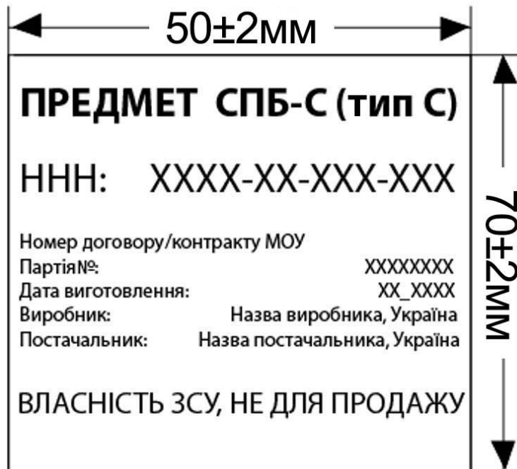
Рисунок 1 - Зовнішній вигляд товарного ярлика та його розміри
