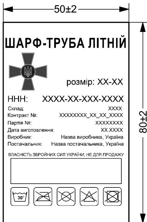
Рисунок 1 – Зовнішній вигляд товарного ярлика та його розміри
