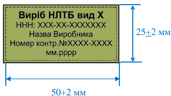
Рисунок 2 — Зовнішній вигляд етикетки та її розміри
