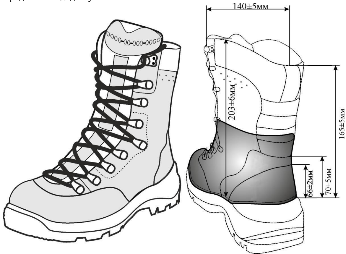
Рисунок Б2 - Черевки Бойові (ЧБ) Тип – А (демісезонні), Черевки Бойові (ЧБ) Тип – Б (зимові утеплені). Схема місць вимірювання черевика
