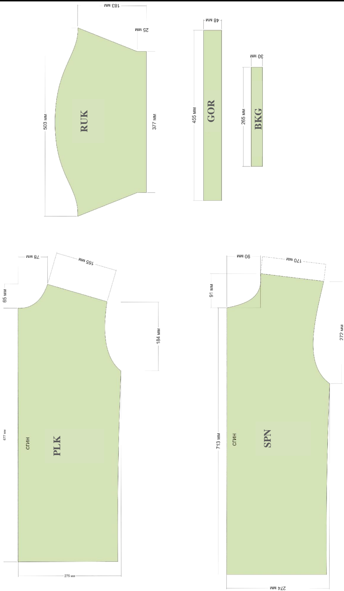
Рисунок Б2.1 — Ескізи лекал деталей виробу
